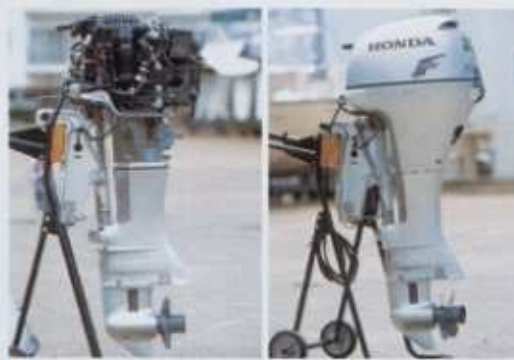
ガスアシストチルトを装備したホンダBF20(電動チルト仕様もあり)。他メーカーでよく見かける25馬力船外機に比べると、非常に軽量コンパクトにまとまっている。部品に使用済み漁網などを再生利用し、リサイクル率95%を達成するなど、排ガス規制だけでなく、環境に十分配慮したエンジンとなっている
