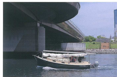
上: マストは、標準装備される「Mastend」 という独自のシステムによって簡単に起倒する。本来はトレラリグ用に考案されたものだが、波さえなれば海上でも問題なく操作できる 左: マストを折り込んだ状態でのエアドラフトは約1.6m。トレラリグを前線にしているキャットリグなので、後ろ方向へのマストの出っ張りも少ない
