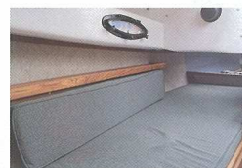
左: 取材時(バキューズ)オーナーの露崎茂夫さん/由美さんご夫妻。1年前に購入して以来、月に4~5日はマリナに来るようになったという。「原付き感覚で、気軽に乗れるのがホライゾンキャットのいいところ」(茂夫さん) 中: 同船にあるクォーターバースは、それぞれ長さ2.05m、幅0.7mという余裕のサイズ(写真は左舷側) 右: キャビン内の高さは120cm。38リッターの清水タンク、アイスボックス、ポータブルマリントイレ、シンク2つが標準で装備される
