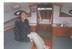
左: 取材時(バキューズ)オーナーの露崎茂夫さん/由美さんご夫妻。1年前に購入して以来、月に4~5日はマリナに来るようになったという。「原付き感覚で、気軽に乗れるのがホライゾンキャットのいいところ」(茂夫さん) 中: 同船にあるクォーターバースは、それぞれ長さ2.05m、幅0.7mという余裕のサイズ(写真は左舷側) 右: キャビン内の高さは120cm。38リッターの清水タンク、アイスボックス、ポータブルマリントイレ、シンク2つが標準で装備される
