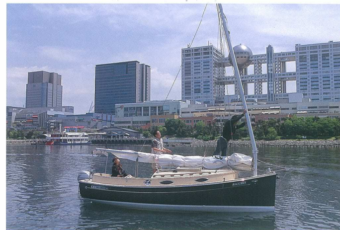
上: マストは、標準装備される「Mastend」 という独自のシステムによって簡単に起倒する。本来はトレラリグ用に考案されたものだが、波さえなれば海上でも問題なく操作できる 左: マストを折り込んだ状態でのエアドラフトは約1.6m。トレラリグを前線にしているキャットリグなので、後ろ方向へのマストの出っ張りも少ない
