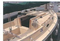
左: 取材時は、オリジナル仕様のステアリングホイールをティラーに変更、またトランスにあったトラベラーも、コクピット中央に移動している 右: デッキ全長。オープンボードやチークのハンドル、ウインチ2つは標準装備。メーカーオプションとして、7馬力ディーゼル船外機、専用ビミニコップ、コクピットクッションが用意されている
