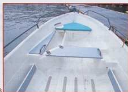
3. 左舷腰掛けの蓋は、45度にカットされた部分にヒンジがあり、開くと船首尾線に垂直なベンチとしても利用できます。なお、船首のクッションはオプション
