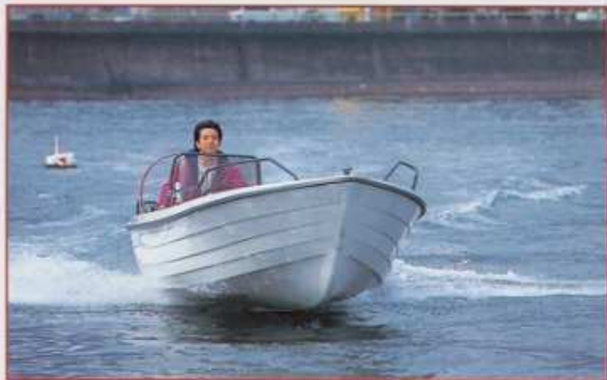
15ノットほどの航走。きれいに滑走しているのが分かります。わずかに船首を上げた、ごく自然な姿勢です
