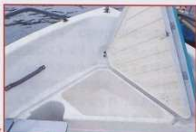
7. 船首の物入れ。左の切り欠いてある部分は左舷の腰掛け下の物入れに通じています。水を溜めてイケスとして使う場合などには、こちらから魚を放り込むのがいいようです
