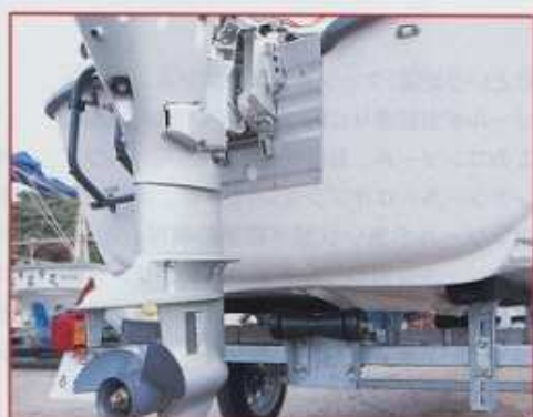
8. 船底中央部がわずかに凹んだ形状の船底。キール部分には、わずかに突出したスケグが見えます
