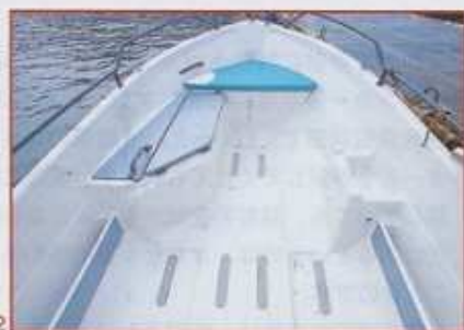
2. 船首側は非対称で、左舷に内部がフィッシュボックスの腰掛け、右舷には小物置きというが倒入れというが、そういったものが成形されています
