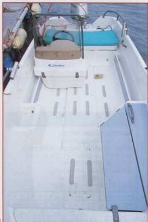
1. 船内はかなり複雑な凹凸のある形状ですが、基本的には一発で成形されています。床は中央部分だけが平らですが、深さは十分に確保されています
